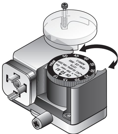
Для регулировки реле давления газа необходимо подключить манометр к месту измерения 1 клапана DMV. При определении момента переключения следить, чтобы он был не ниже половины регулировочного давления, и значение CO составляло < 1000 ppm.
