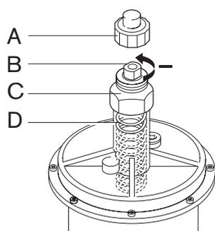
1. Снять защитный колпачок. Вращением регулировочной гайки В влево ослабить пружину. Вращать до упора.
