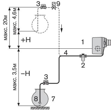
Рис. 2 - двухтрубная система
